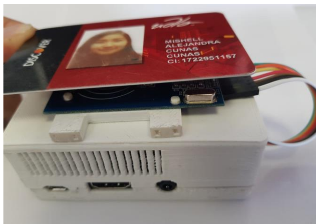
Figura 78. Lectura del Carnet Prueba 2 con el Módulo RFID RC522
