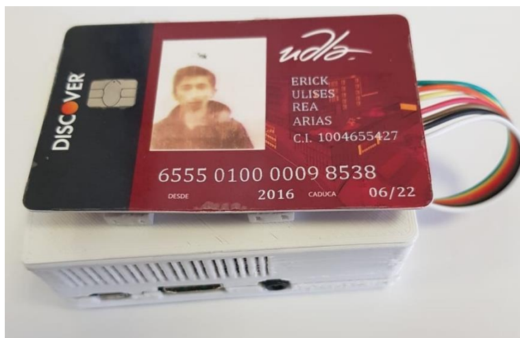
Figura 77. Lectura del Carnet Prueba 1 con el Módulo RFID RC522
