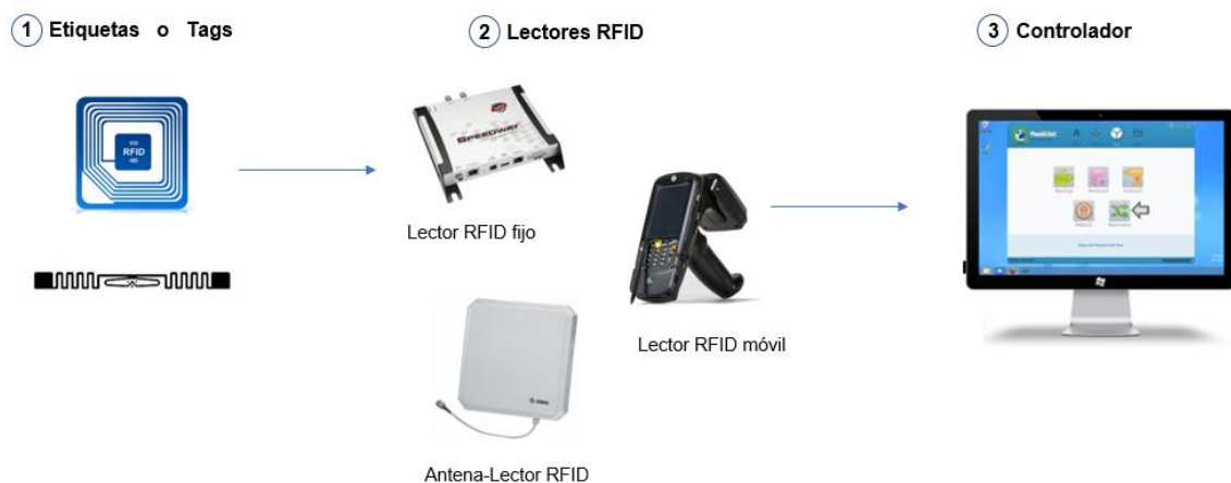
Figura 1. Diagrama del funcionamiento de los sistemas RFID
