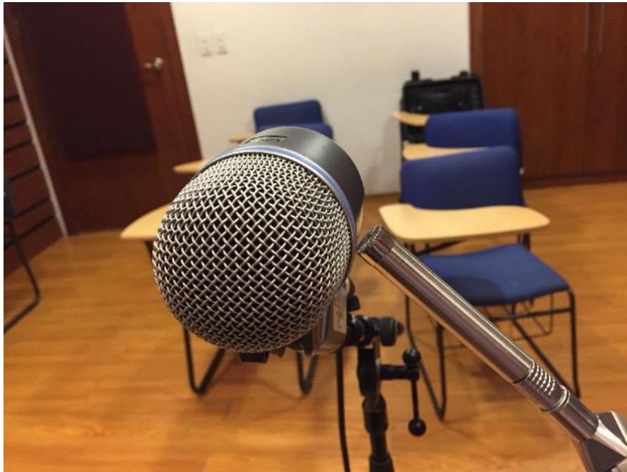
Figura 87. Ubicación de las capsulas Beta 52 y sonómetro para comprobar nivel presión sonora en la sala.
