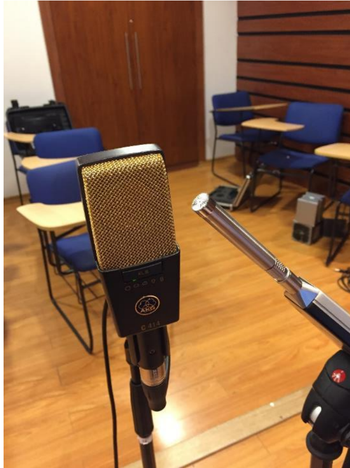
Figura 83. Ubicación de las capsulas C414 y sonómetro para comprobar nivel presión sonora en la sala.
