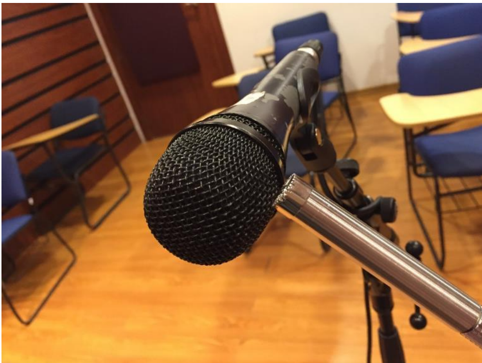
Figura 80. Ubicación de las capsulas Sennheiser e835 y sonómetro para comprobar nivel presión sonora en la sala
