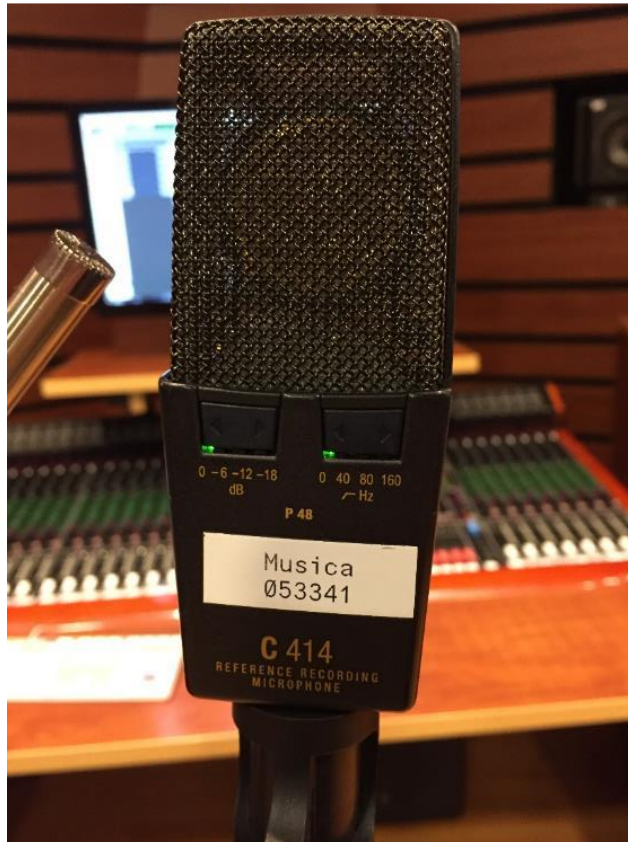
Figura 85. Filtros desactivados C414
