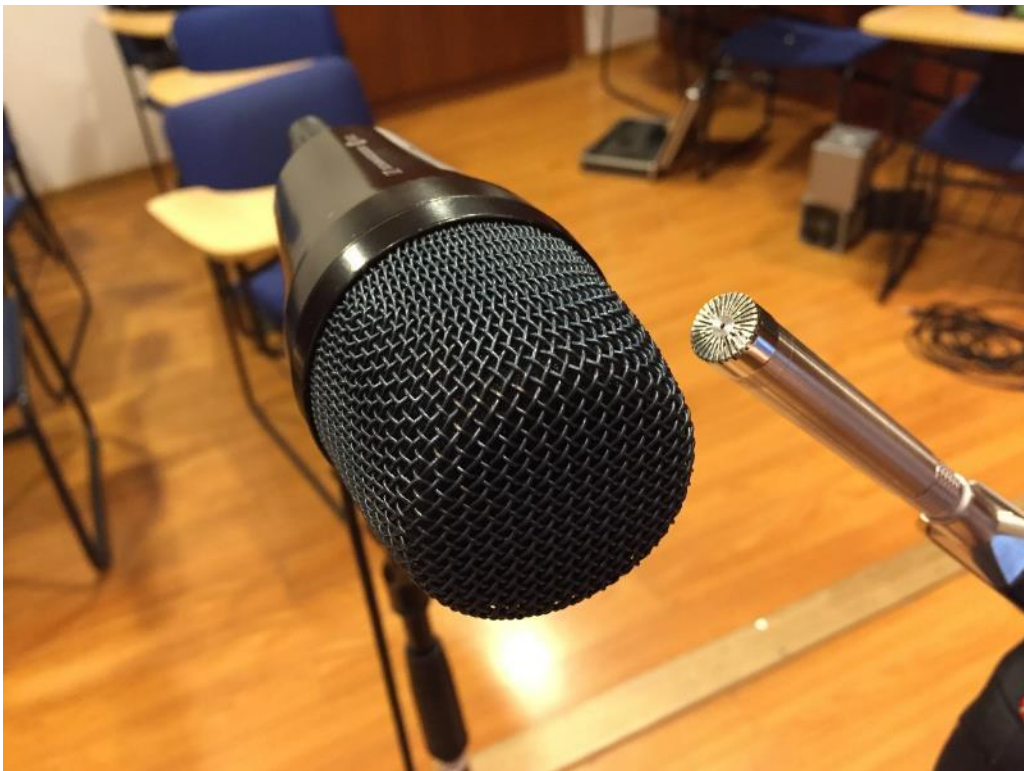
Figura 90. Ubicación de las capsulas e902 y sonómetro para comprobar nivel presión sonora en la sala.
