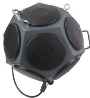
*Figura 35.* Fuente omnidireccional Cesva BP012.
