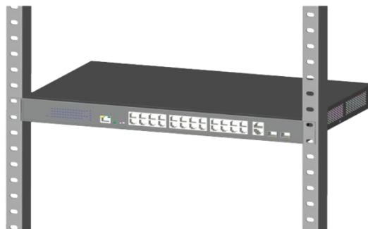
Figura 18. Switch instalado en el rack.
