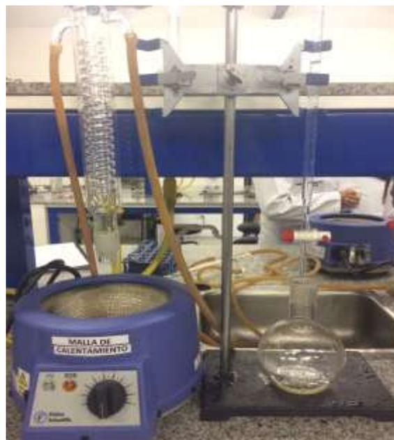
*Figura 24.* Determinación de fibra
