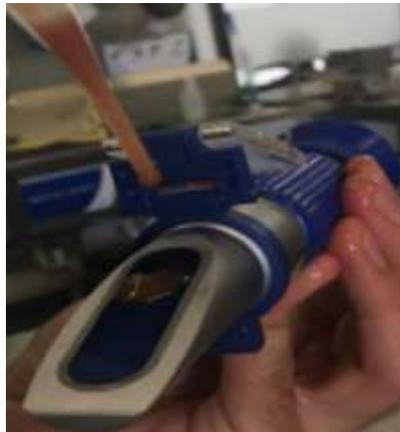
*Figura 22.* Determinación de °brix de la cascarilla de café
