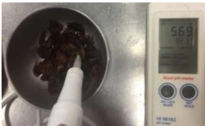
*Figura 21.* Determinación del pH de la pulpa de café
