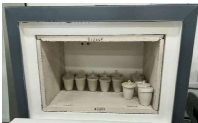
Figura 23. Muestras de la pulpa y cascarilla en la mufla
