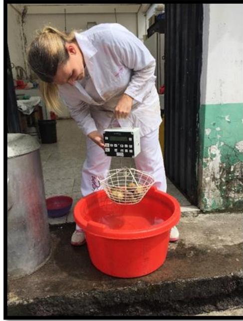
*Figura 1.* Medición de materia seca con Hidrómetro PW – 2050 Weigher.
