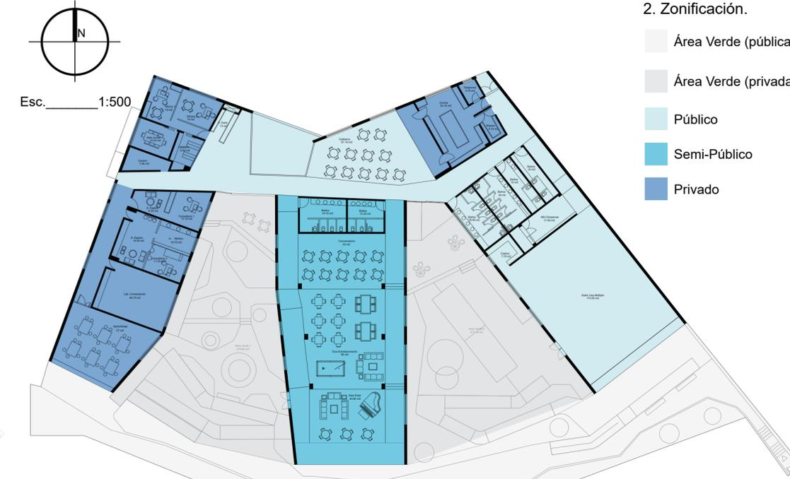
Figura 71. Zonificación Centro Atención 3ra Edad. Adaptado de (Plataforma Arquitectura, 2018).
