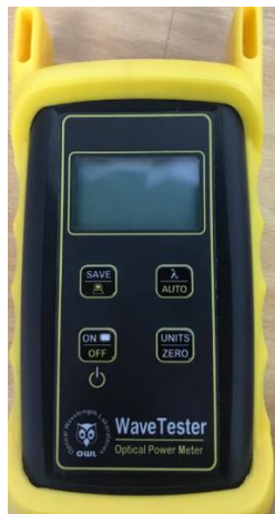
Figura 19. Medidor de potencia / Power Meter.
