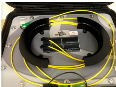
Figura 22. Bobina de lanzamiento de 10Km
