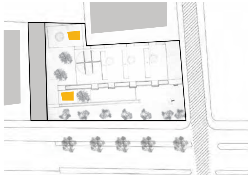
Localización de equipos para la ventilación
