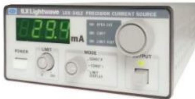
Figura 21. Controladores de diodo láser de bajo costo, LDX-3412
