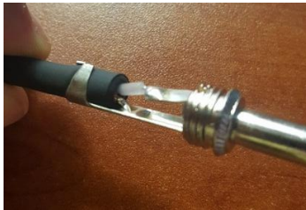
Figura 14. Cable de instrumento unido a plug
