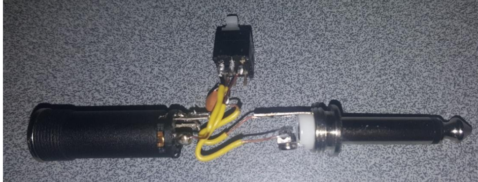
Figura 23. Adaptador con pulsador fuera del chasis
