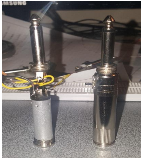
Figura 22. Interior del adaptador (Izquierda) y Producto final (Derecha)
