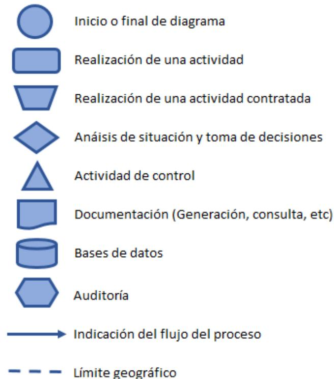
Figura 6. Figuras del diagrama de Flujo.
