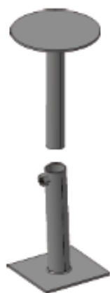
Figura 53. Soporte de Altura-regulable / Utilizado para el módulo de madera
