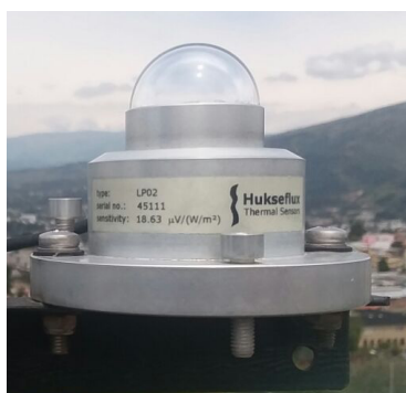
Figura 5. Piranómetro Hukseflux LP02 de la Red Metropolitana de Monitoreo Atmosférico de Quito (REMMAQ).
