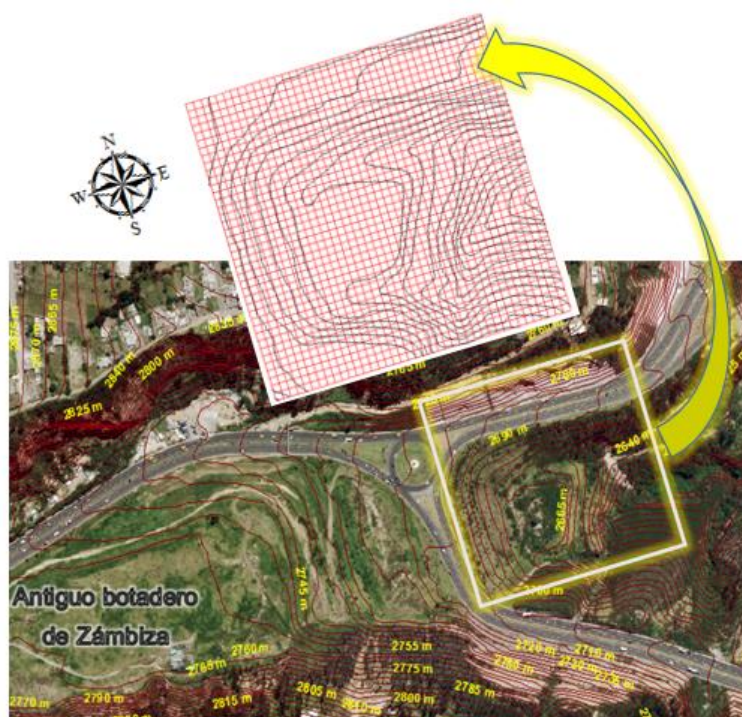
Figura 31. Grilla generada en AutoCAD 2014 para el modelamiento de la posible contaminación.
