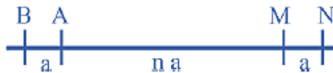
Figura 8. Método Dipolo-Dipolo. Adaptado de Klee, 2016.
