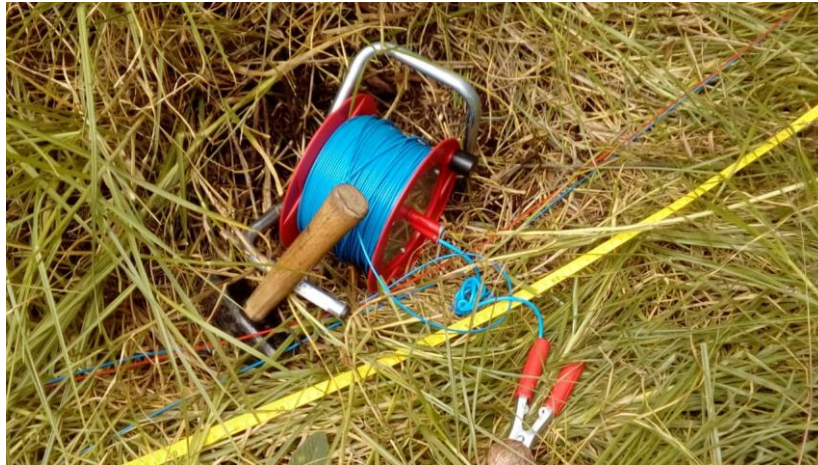
Figura 50. Clavado de electrodo M en el suelo.
