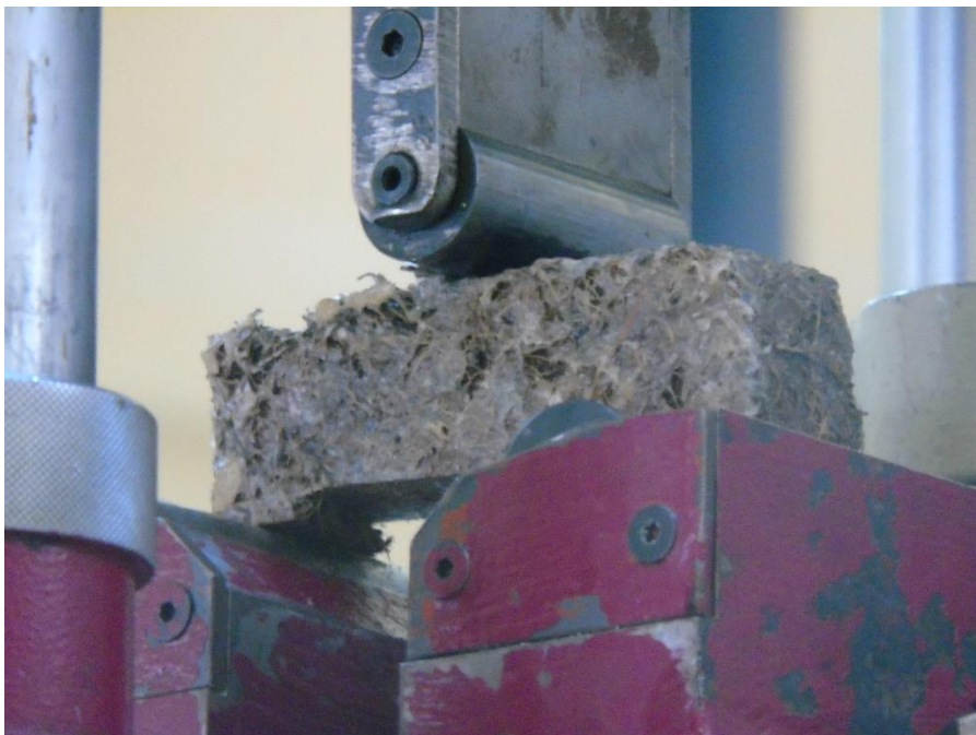
Figura 14 Test de Flexión en aglomerado
