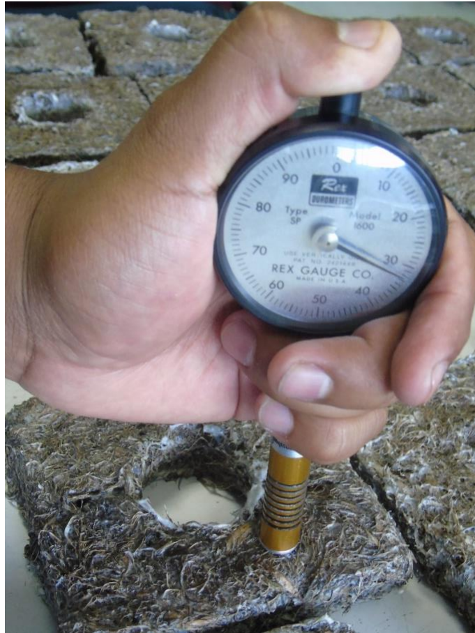
Figura 13 Test de dureza en aglomerado
