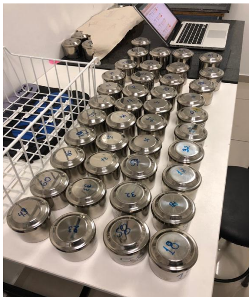
Figura 16: Ensayo de Homogeneidad, capsulas de aluminio
