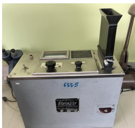
Figura 11. Medidor de humedad INIAP Steinlite Modelo 400g Tomado de (INIAP, 2018)
