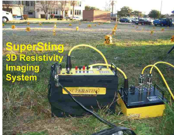
Figura 8. Resistímetro Super Sting R8
