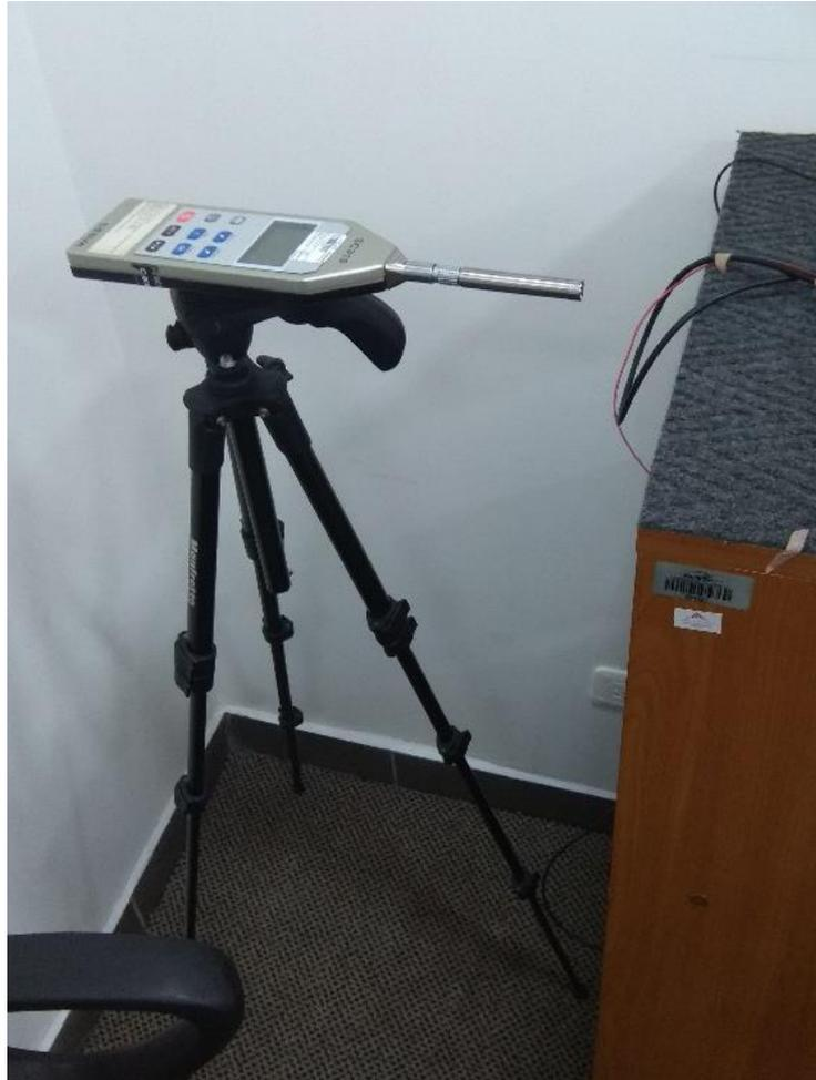
*Figura 25.* Medición del ruido de fondo en la misma posición donde el oyente realizó el experimento.
