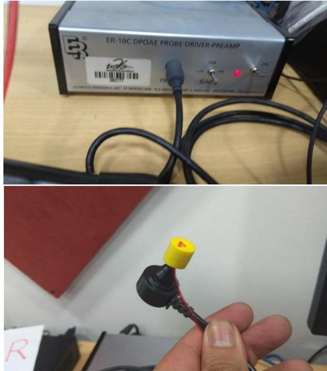
Figura 20. Micrófono tipo sonda Etymotic ER-10C.
