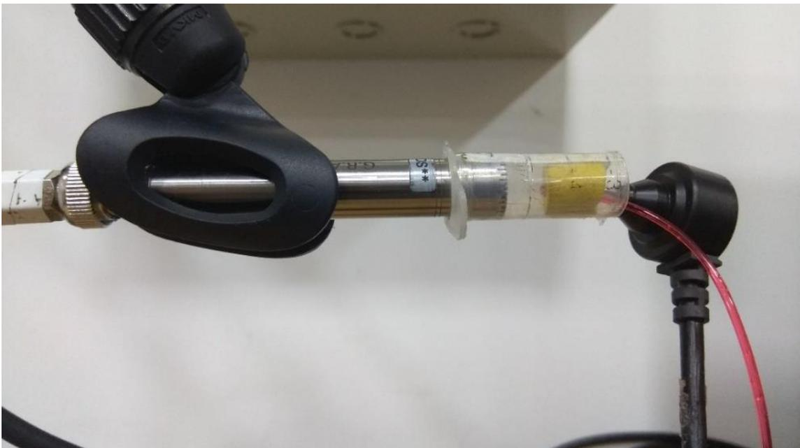
*Figura 22.* Calibración del sistema utilizando un volumen de 1.5 centímetros cúbicos para simular el volumen de la cavidad del canal auditivo.
