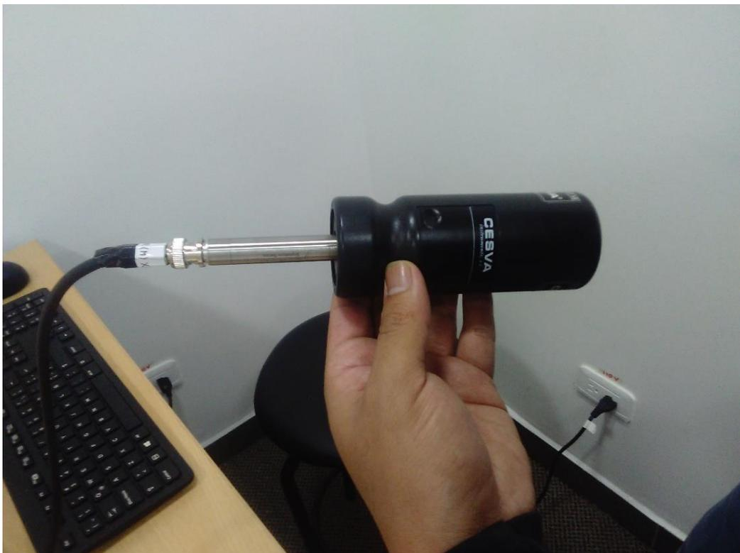
Figura 23. Medición de la sensibilidad del micrófono GRAS 46AO.
