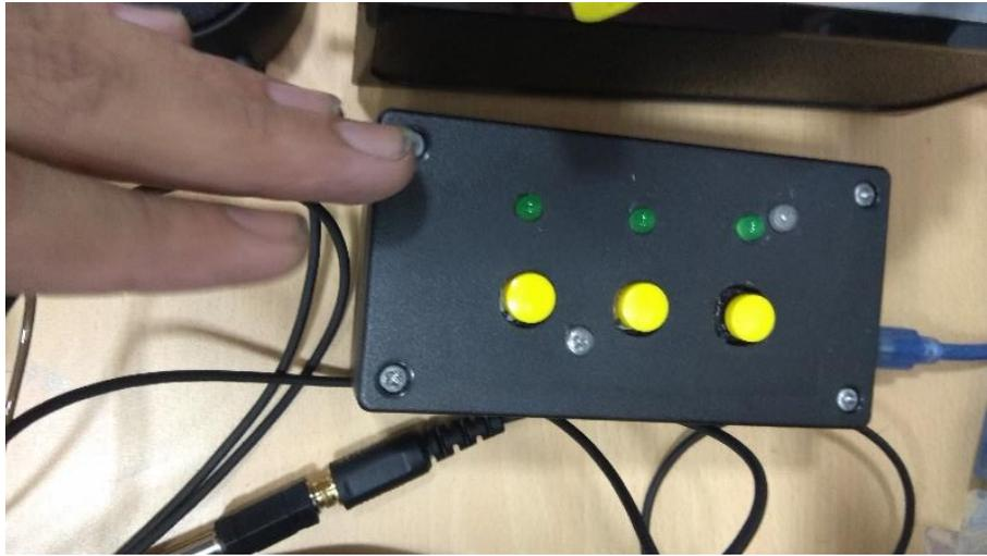
*Figura 19.* Botón de respuesta utilizado para la medición de umbral de audición.
