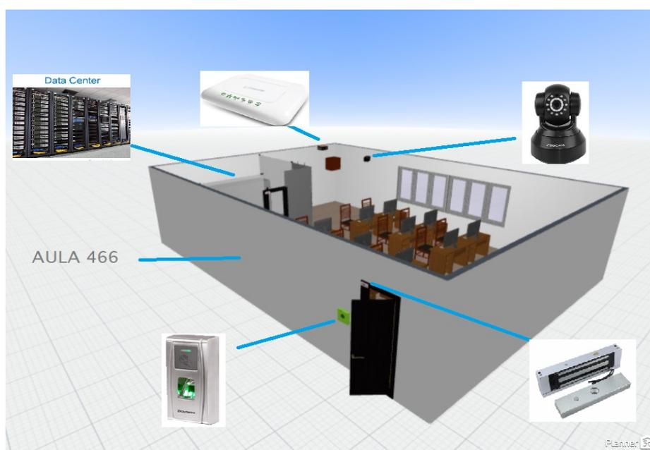
*Figura 105. Diagrama de instalación de los equipos de red.*
