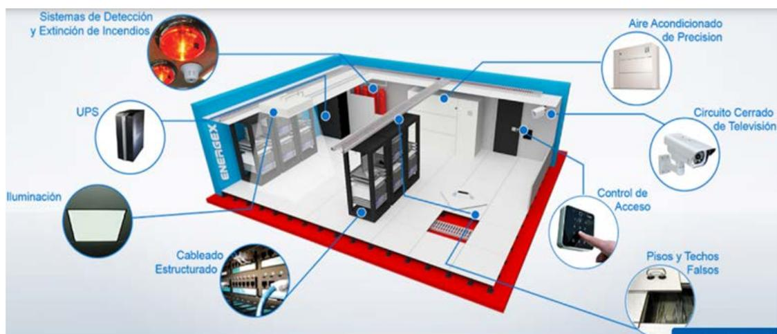
Figura 9. Seguridad física de Data Center.
