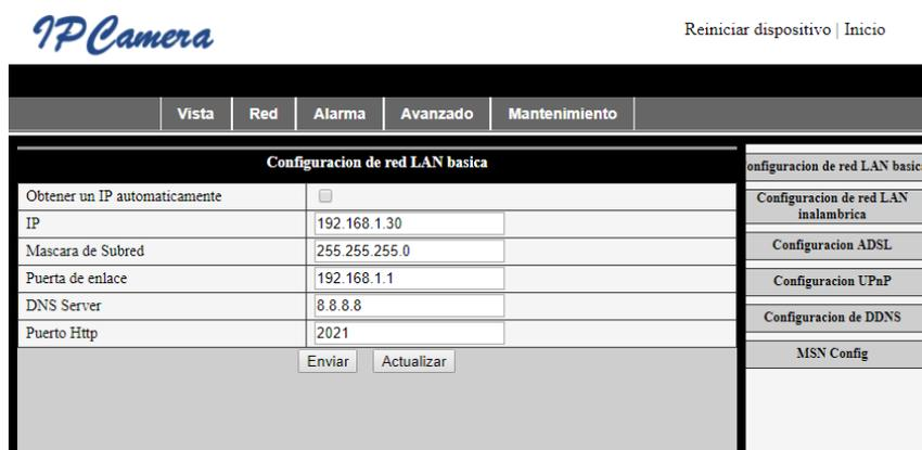
Figura 64. Configuración de red de cámara.
