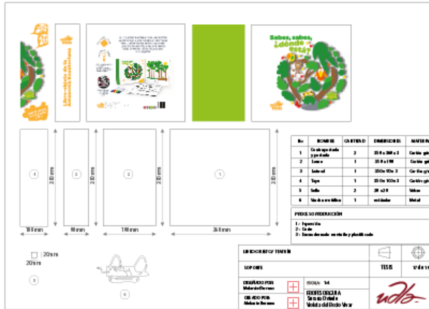
Figura 75. Plano técnico estructura teatrín (encuadernado)
