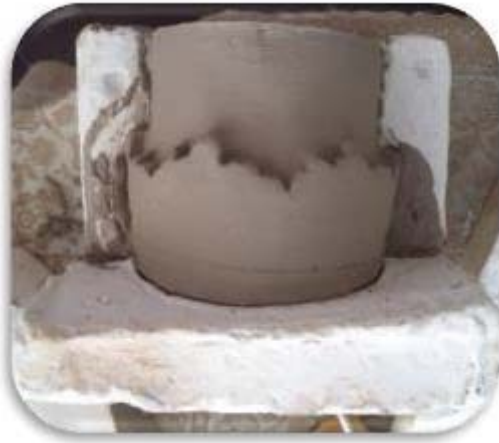
Figura 382. Extraccion de piezas de los moldes
