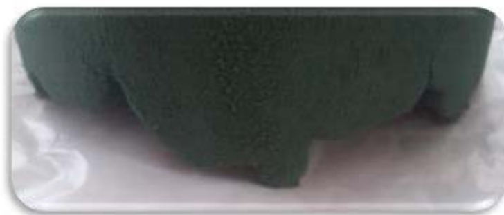
Figura 351. Moldeo de Tapa de azucarera para cortar modulo
