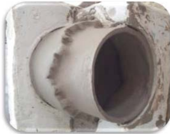
Figura 383. Extraccion de piezas de los moldes
