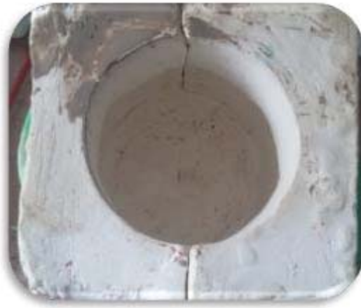
Figura 378. Colocacion de barbotina
