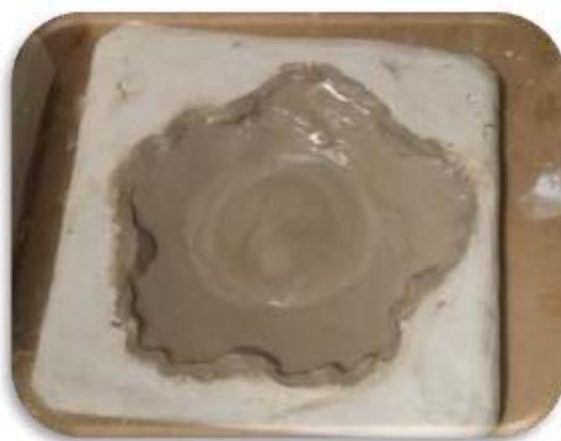
Figura 377. Colocacion de barbotina
