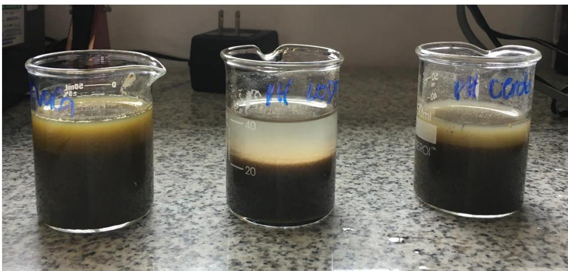
*Figura 17.* Ejemplo de sobrenadante utilizado para pH. Nota. A la izquierda sobrenadante mezcla con estiércol de vaca, en el medio – sobrenadante del lodo secundario y a la derecha – sobrenadante de la mezcla con estiércol de cerdo
