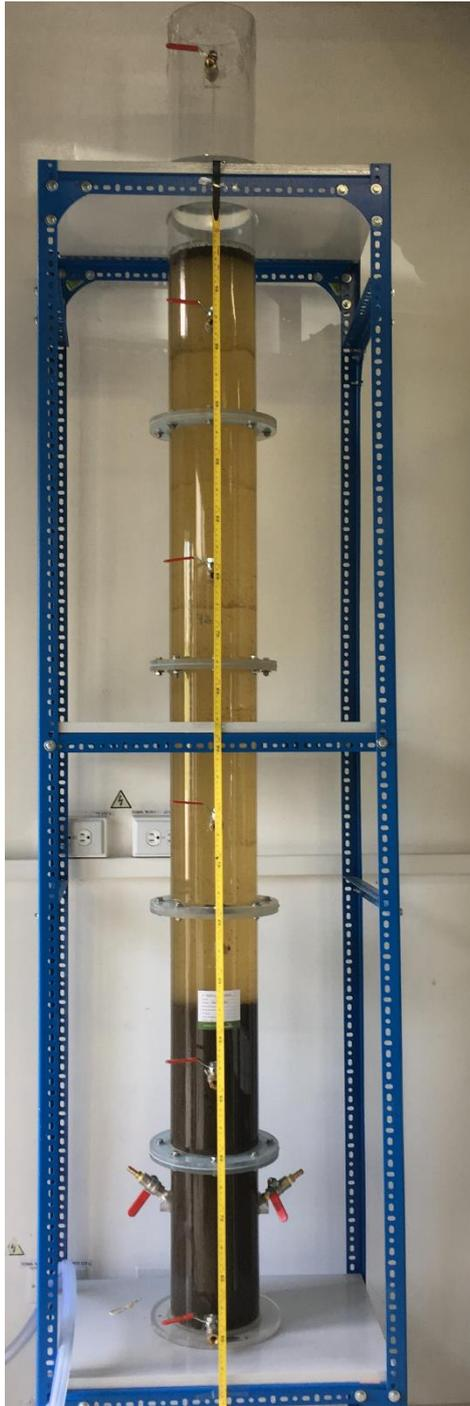
*Figura 20.* Espesamiento físico de los lodos secundarios en la columna de sedimentación
