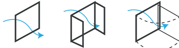
Esquema de Ventilacion Cruzada en ventanas
