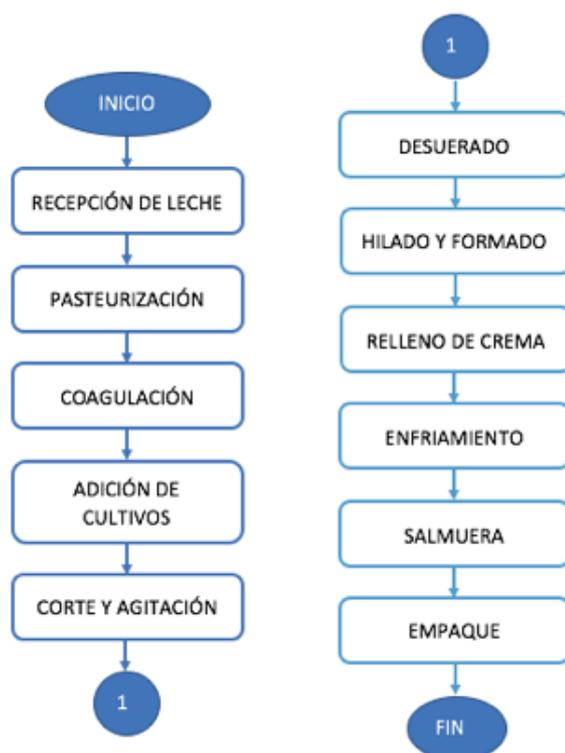
1. Recepción de la Leche: se inicia su análisis para verificar el nivel de acidez, grasa, espesor, etc. Luego se descarga la leche en una tina, con la ayuda de un filtro para reducir las impurezas. Para la recepción y análisis de la leche, es necesario que este insumo cumpla con las siguientes características:
