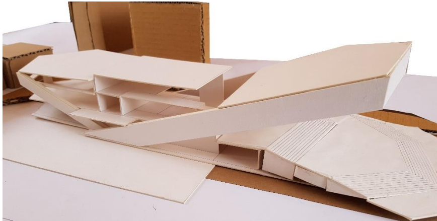
Figura 146. Fotografía maqueta cambio en cubiertas y estructura.
