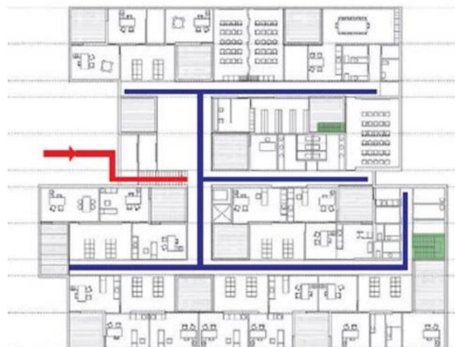
Figura 31. Esquema de circulación
