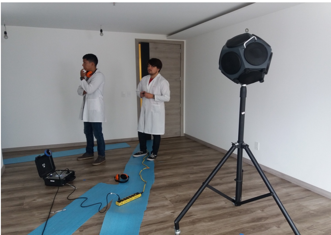
22. Ensayo medición a ruido de fachada
