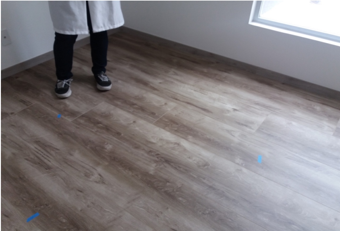
17. Posicionamiento de puntos de recepción – dormitorio
