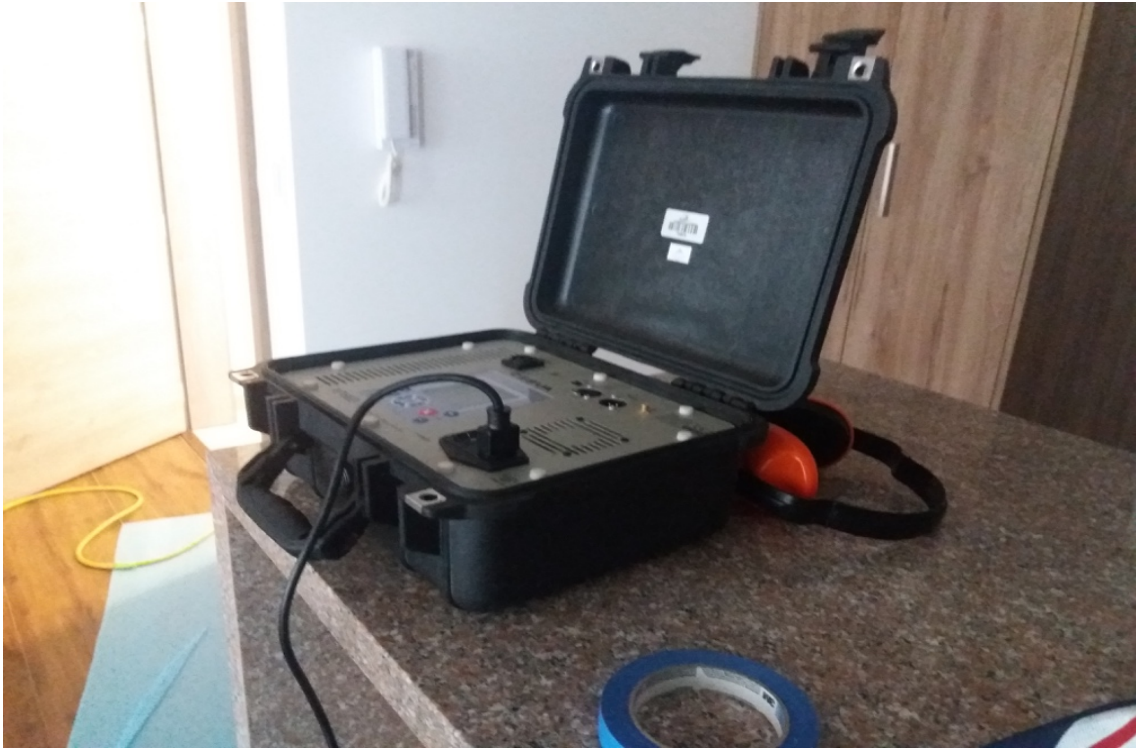
21. Generador de ruido
