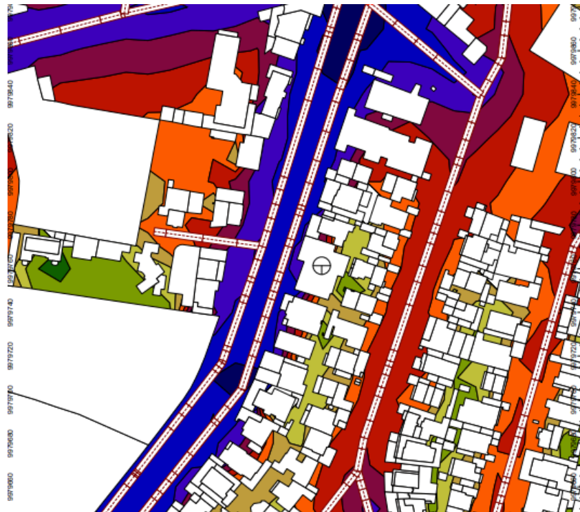
Figura 51. Mapa de ruido del sector del Edificio Goya en horario diurno.
