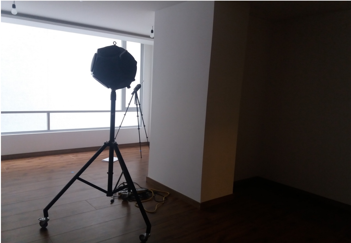
13. Medición emisión con máquina de ruido omnidireccional
