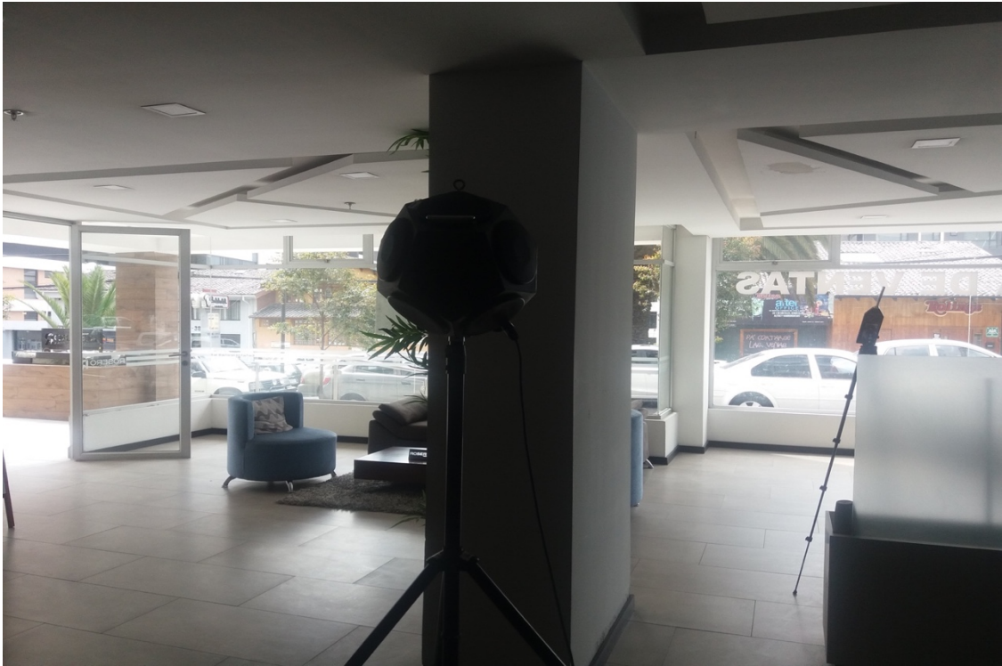
25. Escenario de medición a ruido de fachada
