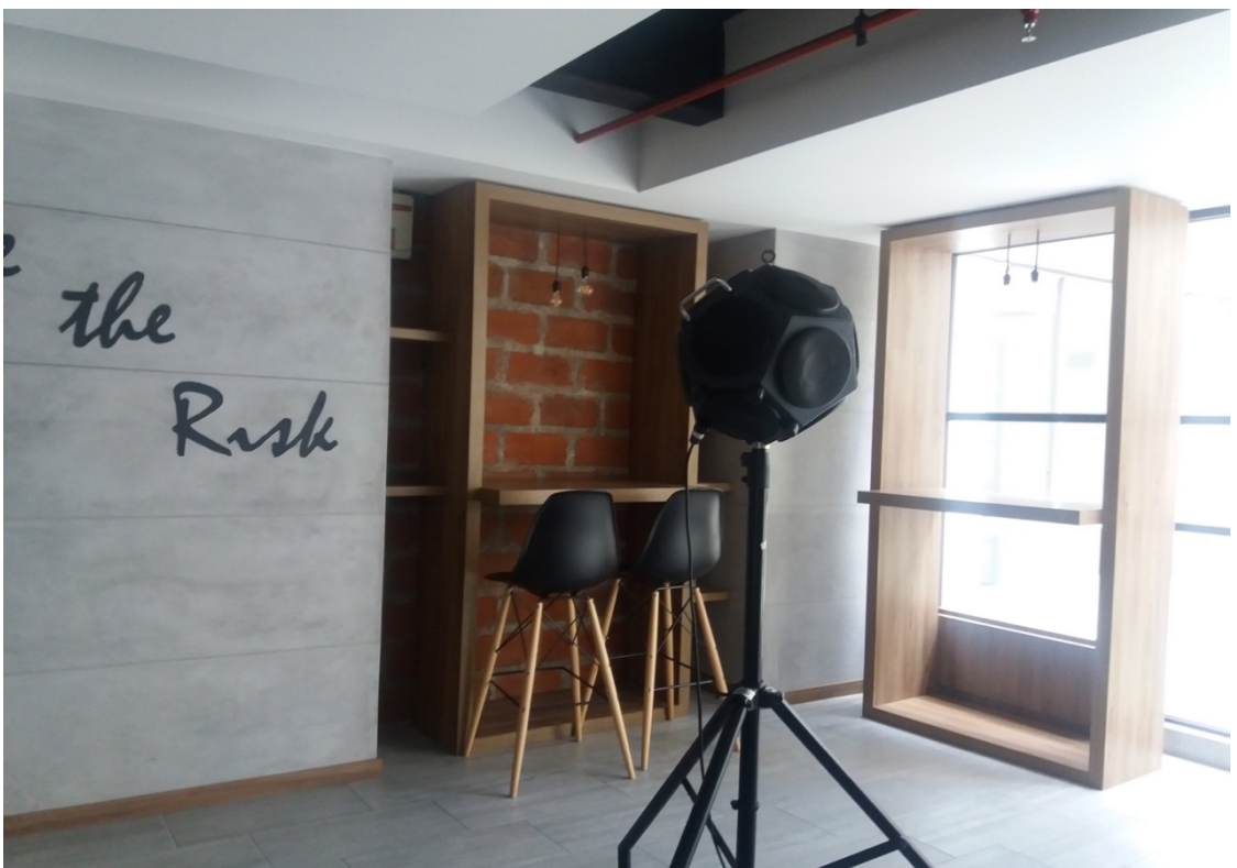
26. Ensayo de ruido aéreo
