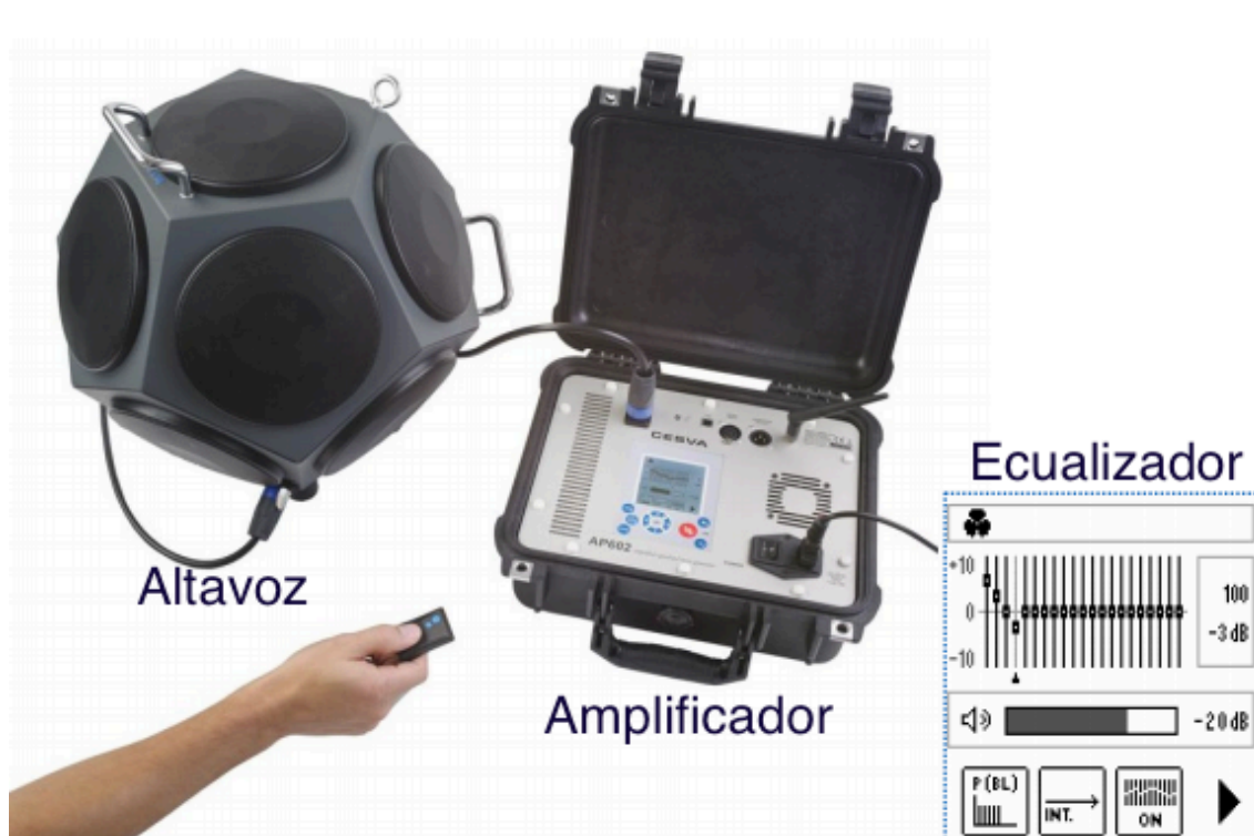
Figura 24. Sistema de fuente omnidireccional (altavoz + amplificador)
