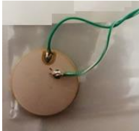
Figura 17: Fotografía de piezoeléctrico con cables soldados.
