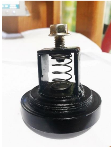
Figura 30: Fotografía de vista lateral de la base del acelerómetro junto con la estructura de sujeción y tornillo.
