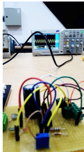
Figura 59: Amplificador de instrumentación conectado a osciloscopio.
