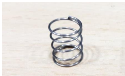
Figura 56: Resorte de 490 N/m destinado al prototipo.
