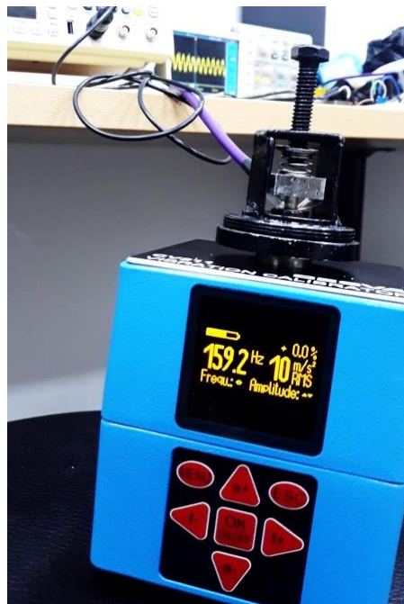
Figura 40: Montaje del transductor sobre el calibrador.
