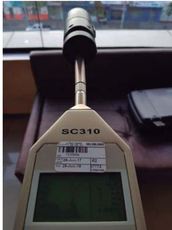
Anexo 12. Calibración del sonómetro en el punto 1 de hospitalización
