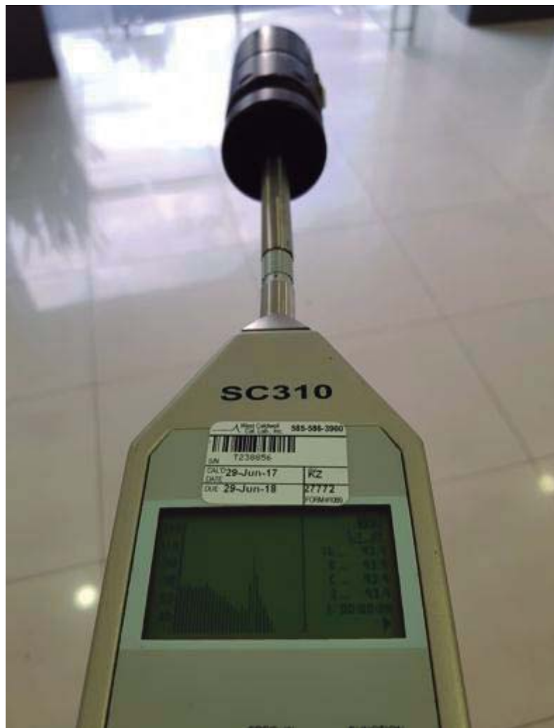
Anexo 5. Calibración del sonómetro desde la zona de información
