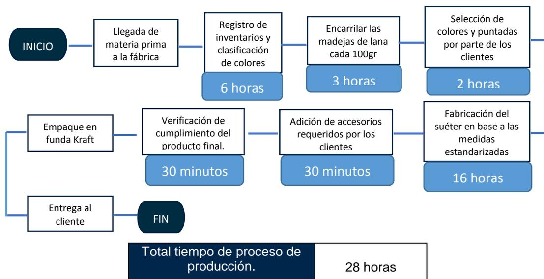
Figura No 15: Flujograma del proceso de producción
