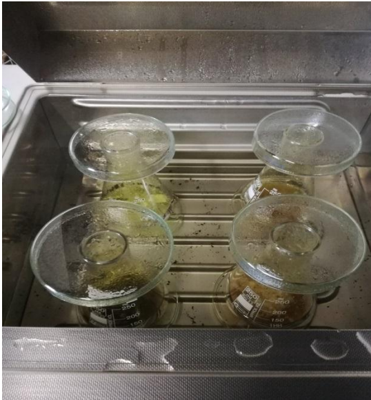
Figura 6. Baño maría para determinación de lignina
