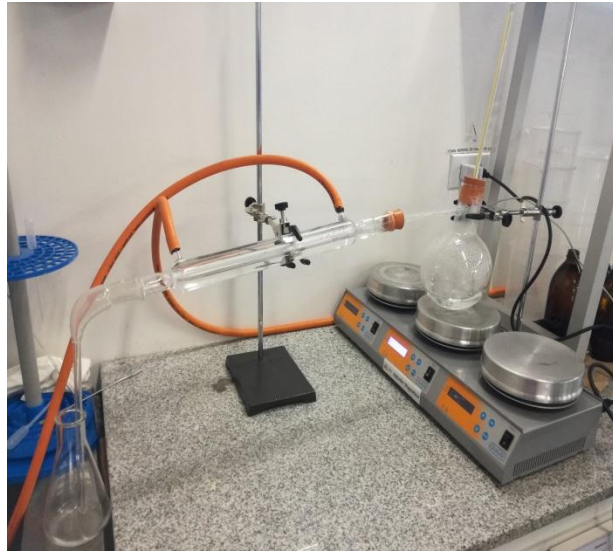
Figura 3. Equipo de destilación
