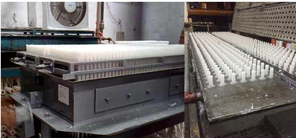
Figura 31. Velas moldeadas en máquina
