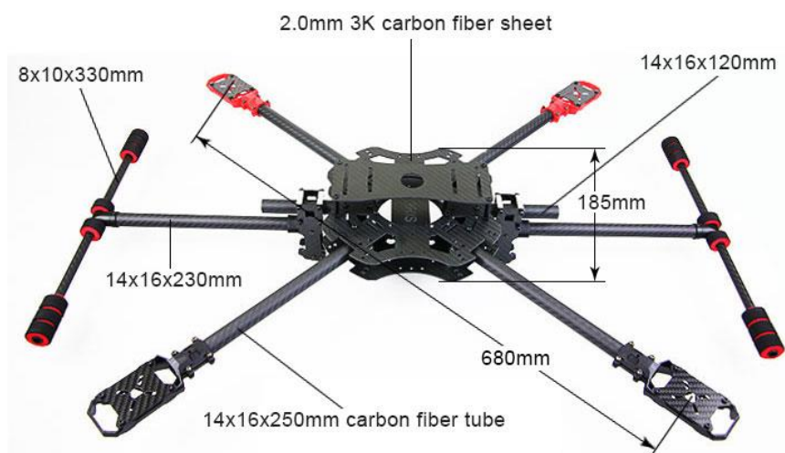
Figura 36. Especificaciones y Dimensiones Dron Arris M880.
