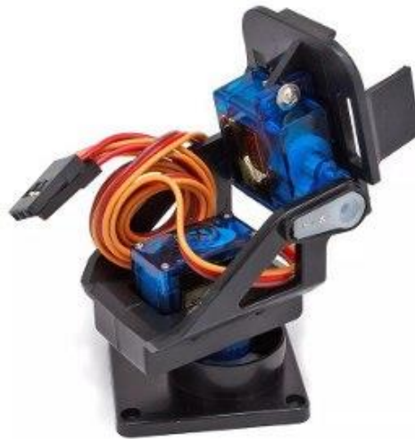
Figura 40. Soporte para servomotores Bracket sg90 y Mg90.
