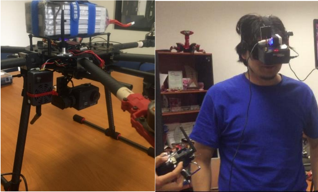
Figura 80. Validación del funcionamiento del Gimbal ubicado en el DRON. (TRAINER ACTIVADO)
