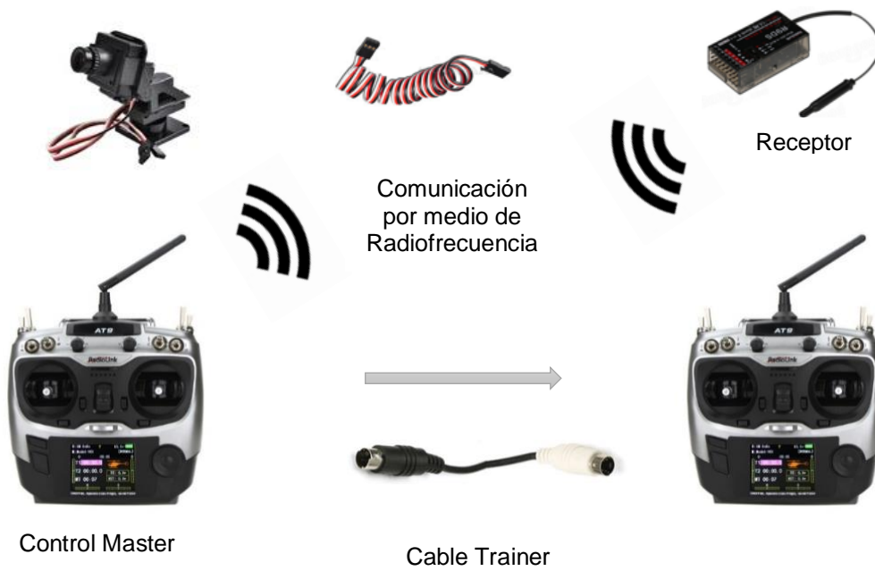
Figura 22. Control Master (parte izquierda) y Control Slave (parte derecha).
