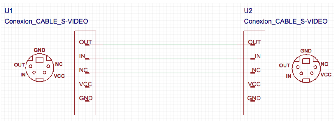
Figura 29. Esquema Cable Super Video
