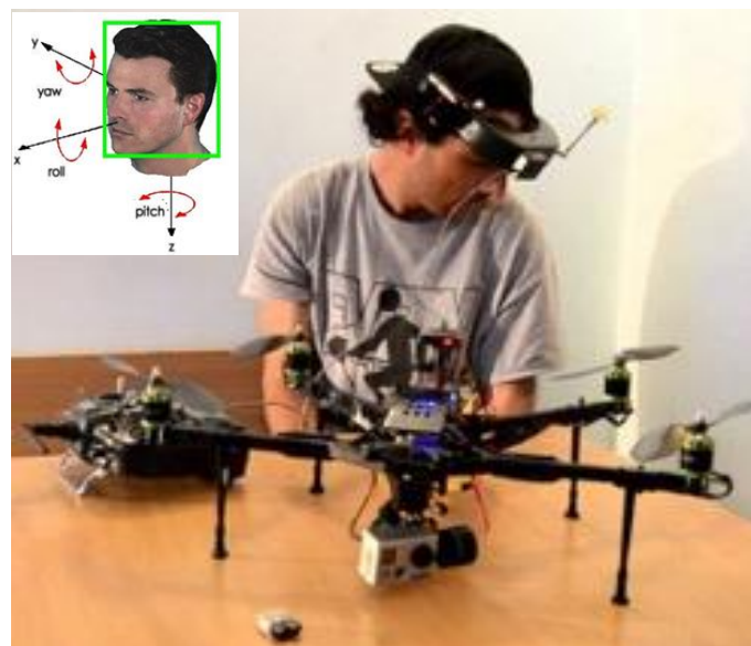
Figura 10. Esquema de un sistema head-tracker más ejes.
