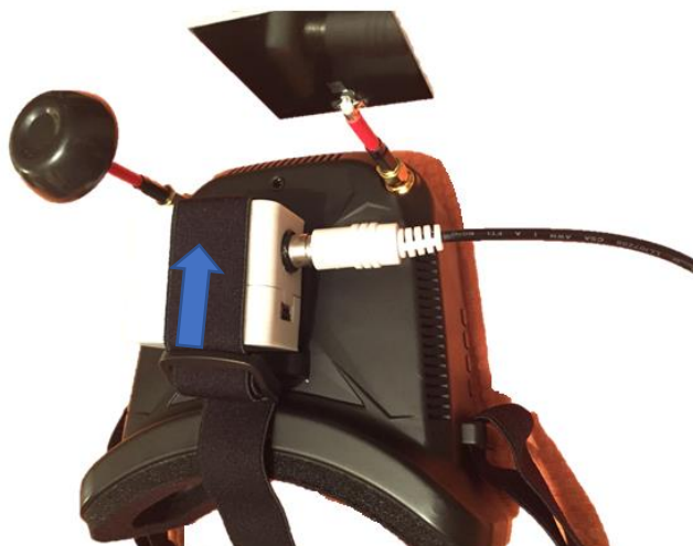
Figura 101. Conexión cable Trainer (extremo color blanco al puerto TRAINER del Prototipo)
