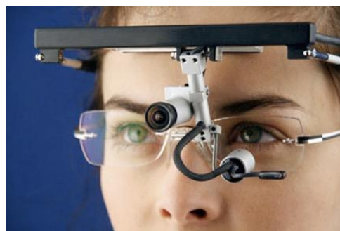
Figura 9. Esquema sistema Eye-tracking
