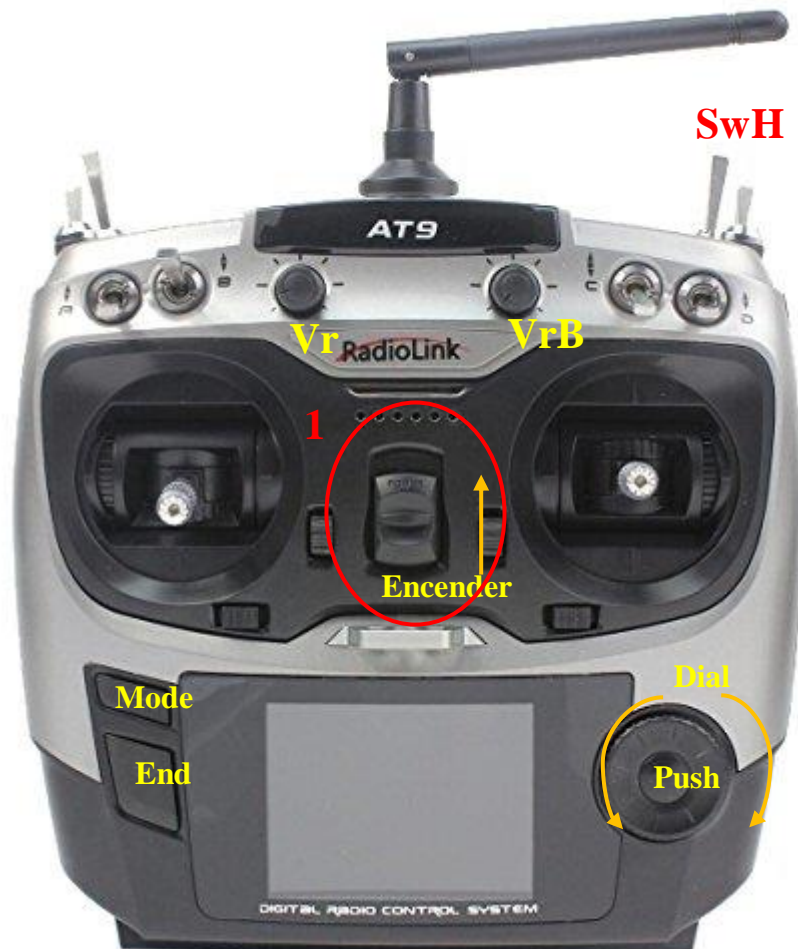
Figura 84. Nombres e Identificadores de botones del control AT9.
