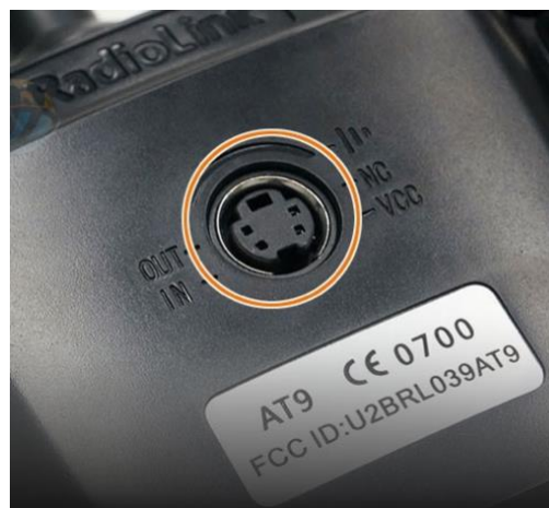
Figura 60. Pin OUT Control AT9
