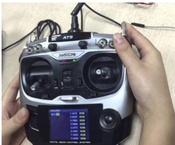
Figura 24. Activación Modo TRAINER con SwH
