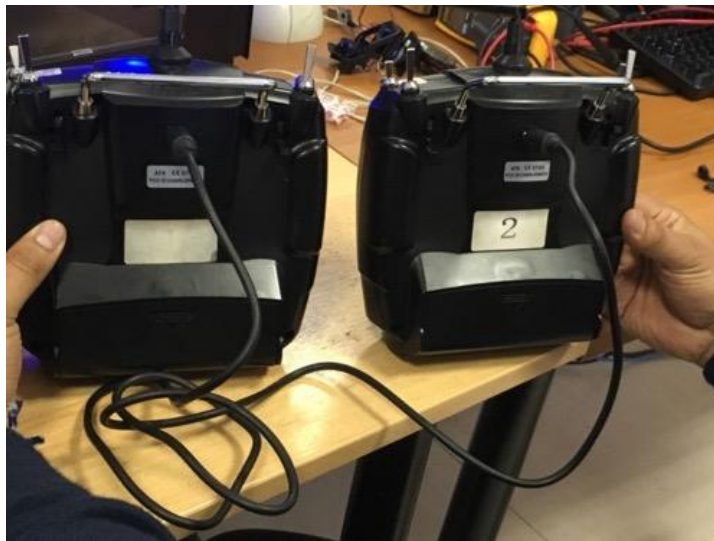
Figura 20. Conexión cable TRAINER entre 2 controles AT9
