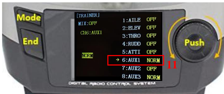
Figura 94. Canal Auxiliar 6 configurado como NORM
