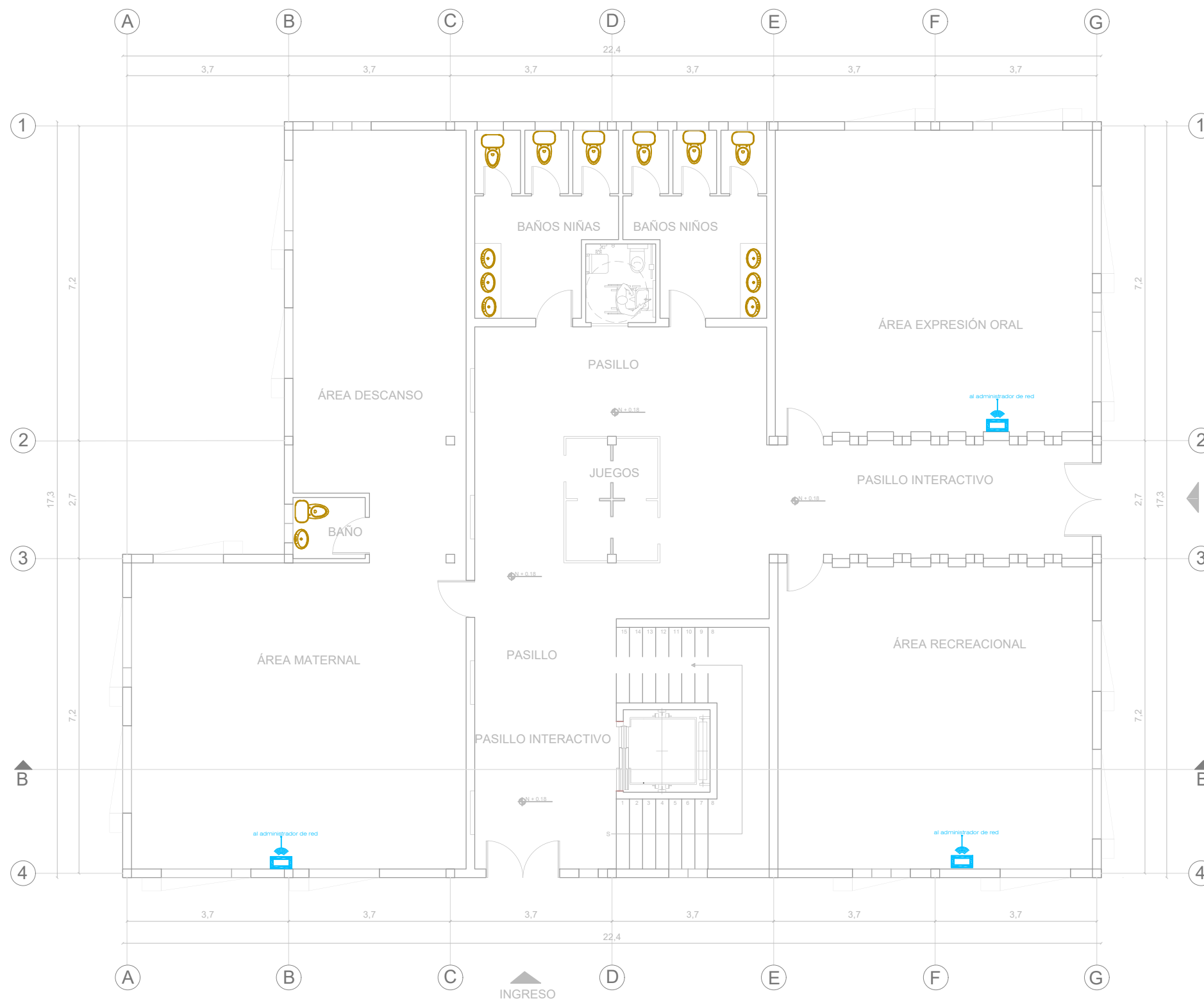
PLANTA BAJA INSTALACIÓN VOZ Y DATOS BLOQUE 2 ESC 1:100
