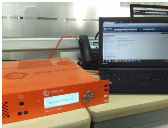
Figura 4. Central Telefónica IP Elastix en Appliance
