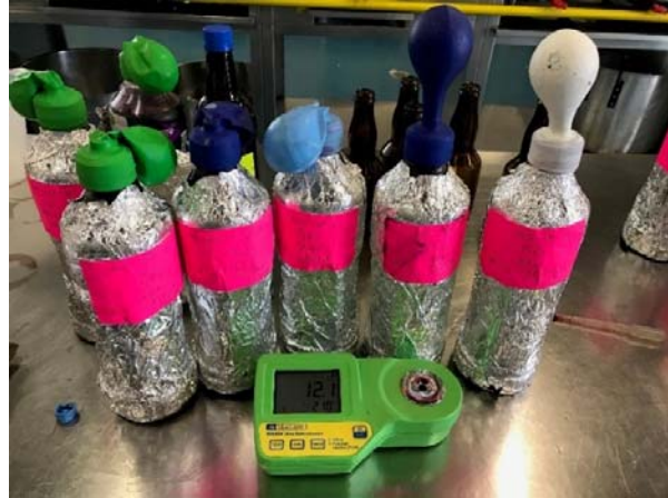
Figura 5. Brixómetro digital con la medición de los grados Brix y potencial alcohólico.
