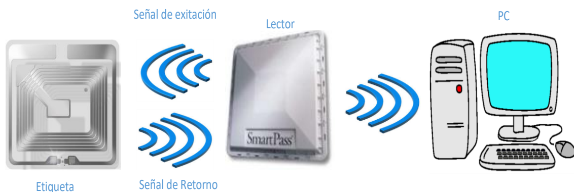
Figura 5. Funcionamiento de la tecnología RFID.
