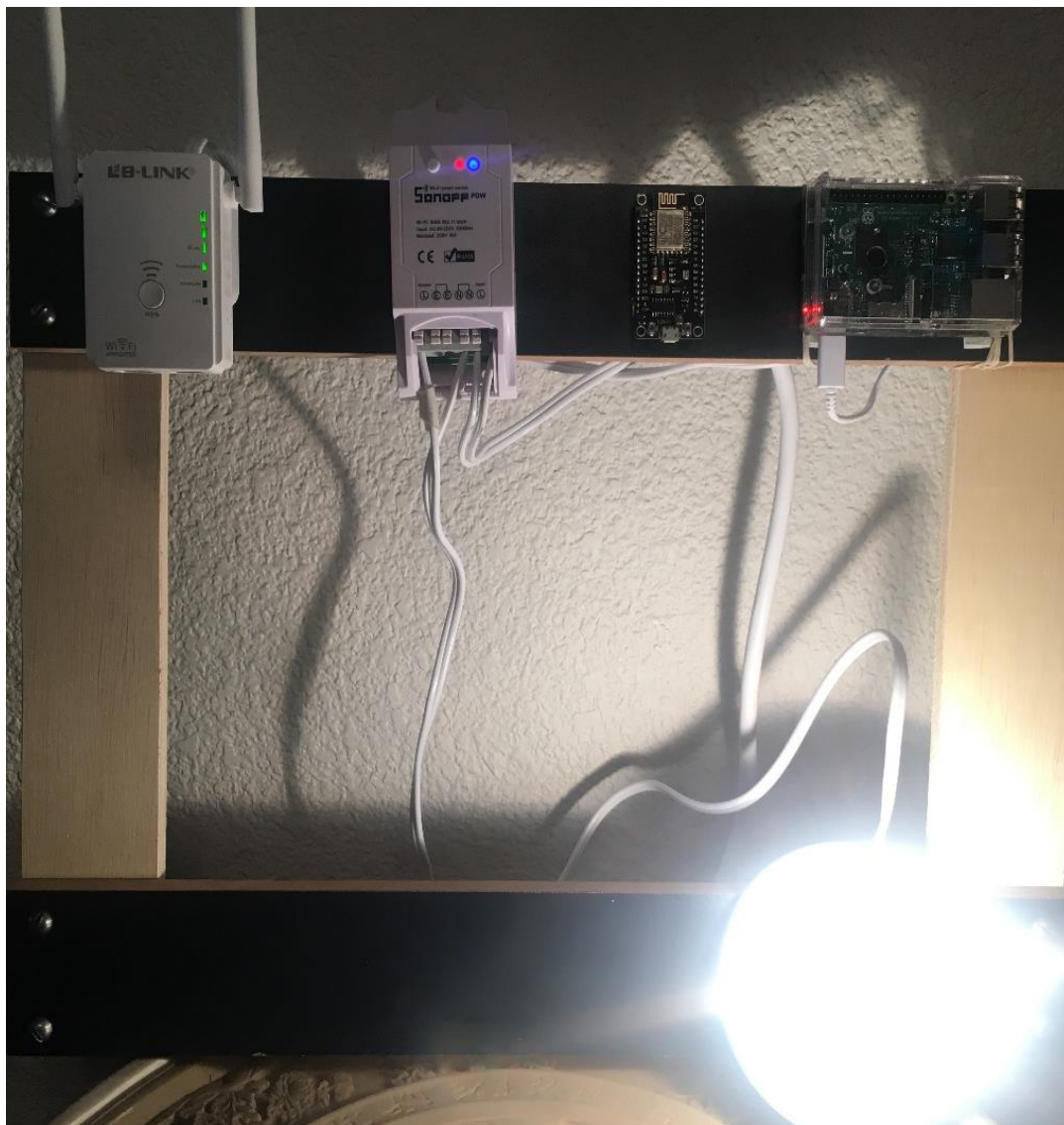
Figura 60. Medición de potencia con prototipo y bombilla incandescente
