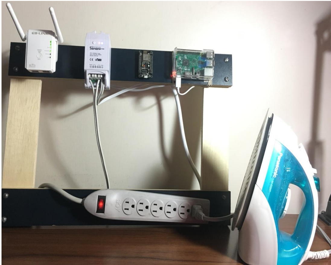
Figura 66. Medición de potencia con prototipo y plancha eléctrica
