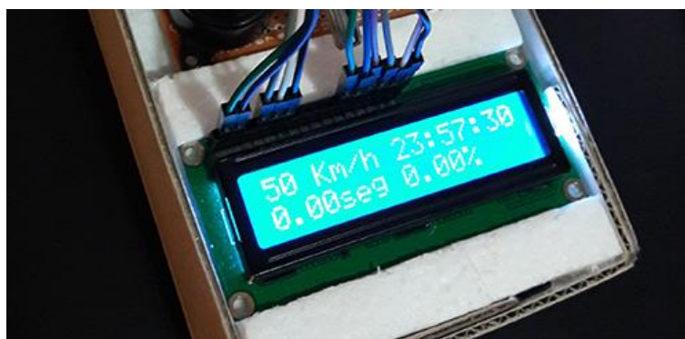
Figura 7. Información inicial en pantalla LCD.
