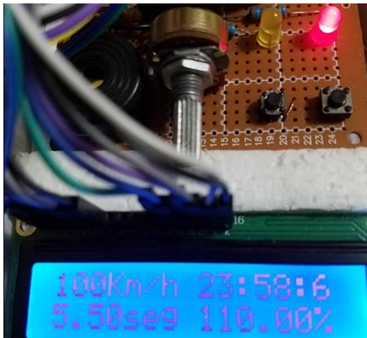
Figura 10. Se continúa pitando hasta sobrepasar el cupo. Se enciende el LED rojo.
