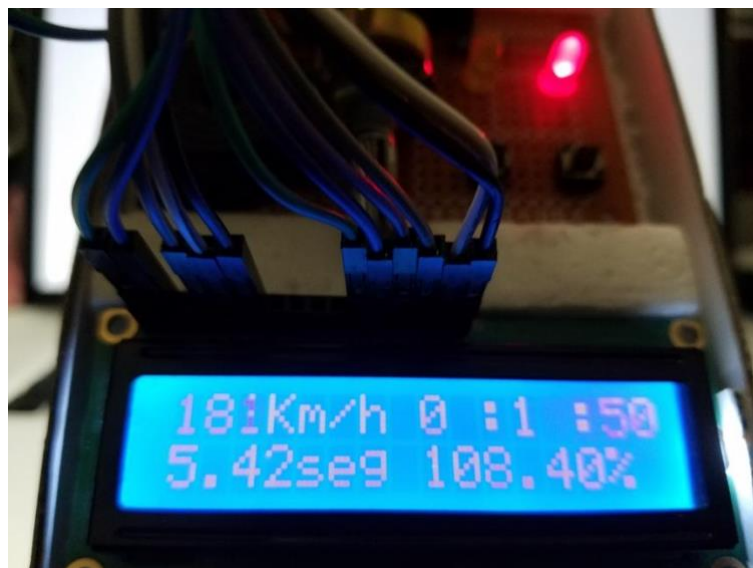
Figura 13. Se pita nuevamente hasta superar el cupo diario. Se enciende el LED rojo.
