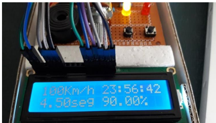
Figura 9. Se alcanza el 90% del cupo. Se enciende el LED amarillo.
