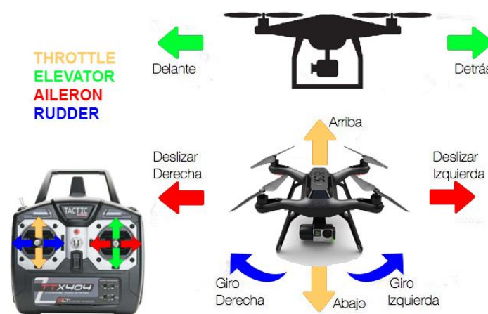
Figura 9. Canales básicos de una radio transmisora. Los cuatro canales básicos controlan Pitch, Roll, Yaw y Throttle.
