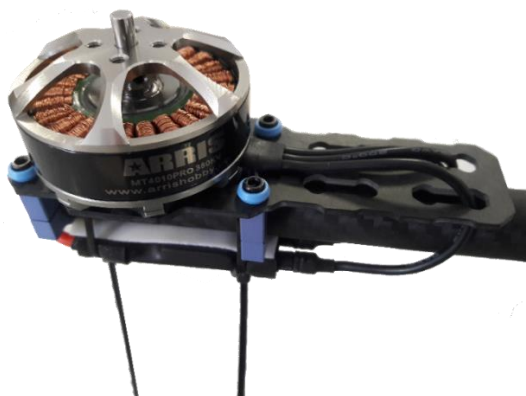
Figura 35. Fijación e instalación de motor y ESC.
