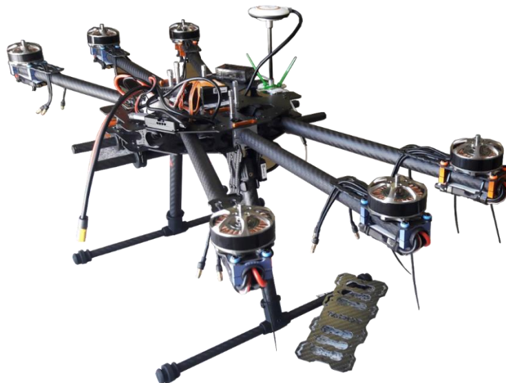
Figura 40. Dron con motores, ESC, etapa de potencia y kit Naza M V2 ensamblados.
