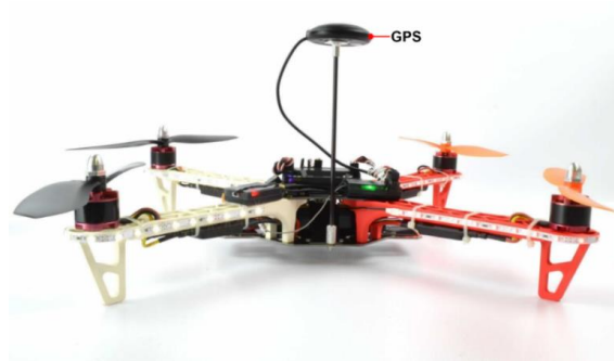
Figura 23. Sistema GPS montado en un cuadricóptero. Tiene una antena que se comunica directamente con el FC. Tomado de X heli, S.F.
