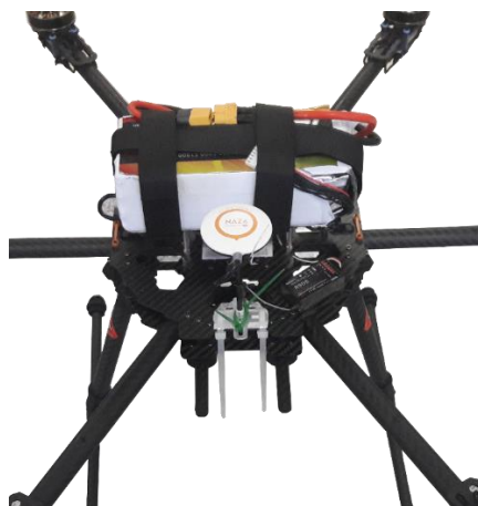
Figura 41. Fijación y conexión de Batería 10000mAh
