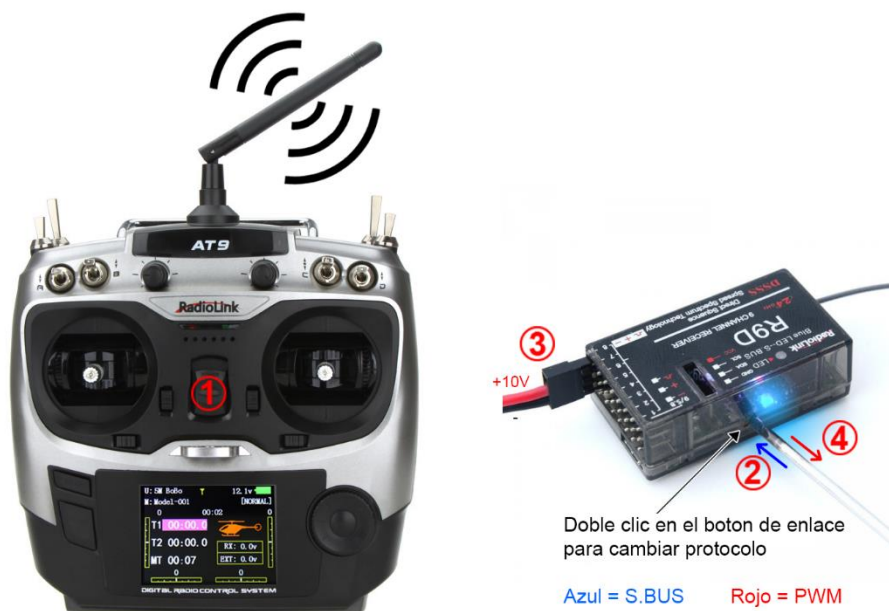
Figura 42. Pasos para enlazar Radio transmisora AT9 con receptora R9D.
