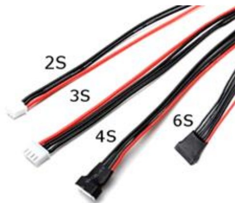
Figura 17. Número de hilos en el cable balanceador. 2S = 3hilos, 3S=4hilos, 4S=5hilos, 6S=7hilos. Tomado de Gonzalo Quiroga, 2016.
