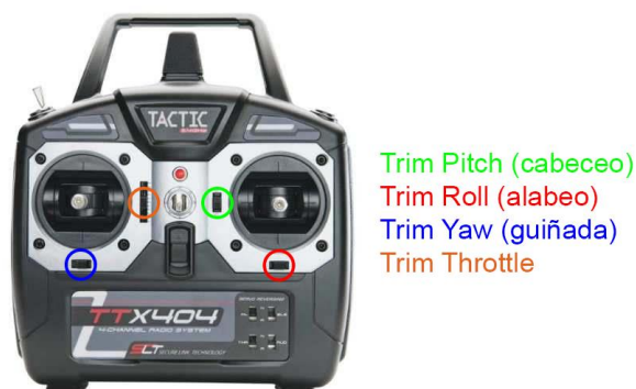
Figura 12. Botones de trimado en una Radio Transmisora TCTIC.
