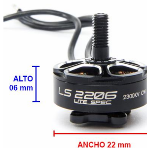
Figura 7. Dimensiones de motor brushless. Motor LS 2206 2300KV Adaptado de RC groups, 2017.
