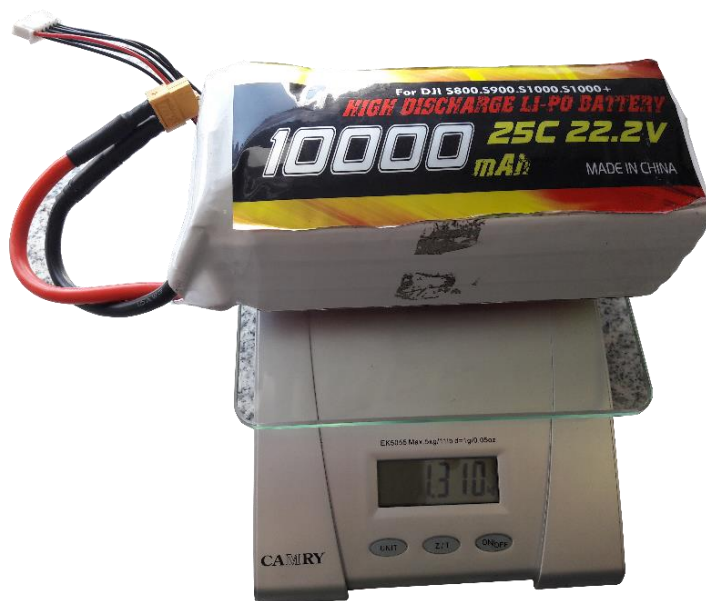
Figura 30. Batería LiPo Masion 6S 10000mAh 25C.
