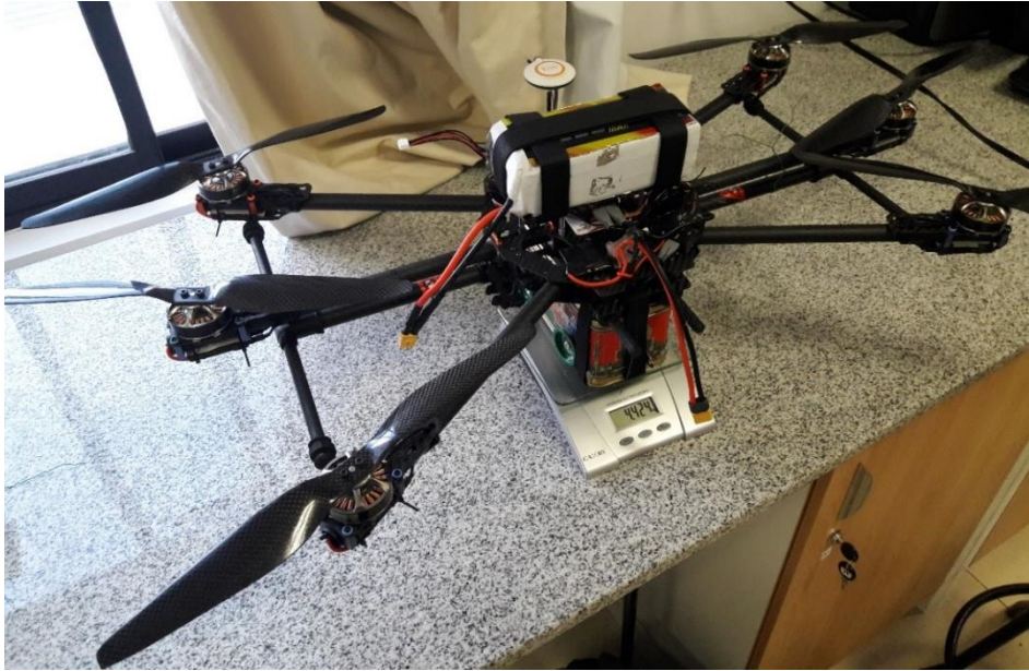
Figura 55. Peso del dron incluida la carga útil de 1.3 Kg y correas de velcro. Peso = 4.424 Kg.
