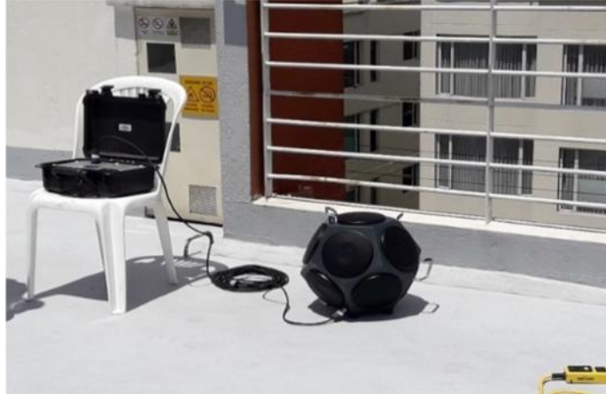
Figura 12. Amplificador, fuente sonora omnidireccional
