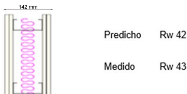
Figura 25. Ejemplo 2 INSUL: Estructura de la partición del ejemplo citado anteriormente.
