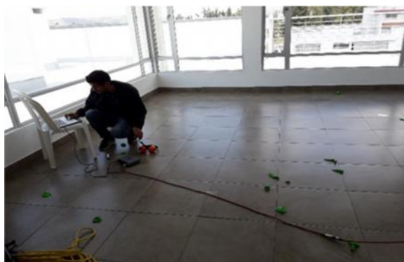
Figura 11. Medición en cada punto respecto a la fuente
