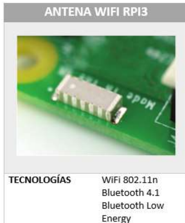
Figura 31. Características de Antena WiFi Raspberry Pi
