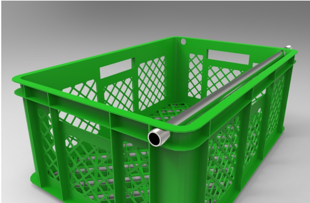
Figura 79. Tubos con rosca en orificios.
