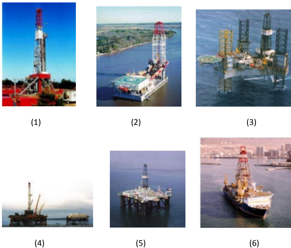
Figura 5. Tipos Básicos de Equipos de Perforación Tomado de: (Schlumberger, 2004, págs. 5-7)
