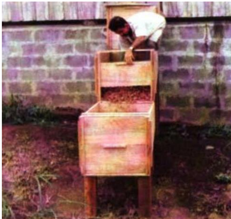
Figura 2. Cajas de fermentación en escalera.
