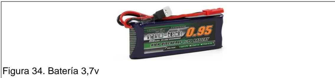
La batería turnigy de 3,7V tiene un peso de 9 gramos ideal para este proyecto por tamaño y capacidad de 950mAh con una capacidad de descarga de 25-50C, con la placa Lipo Rider Pro es el complemento perfecto para la alimentación amigable con el ambiente del nodo sensor.
