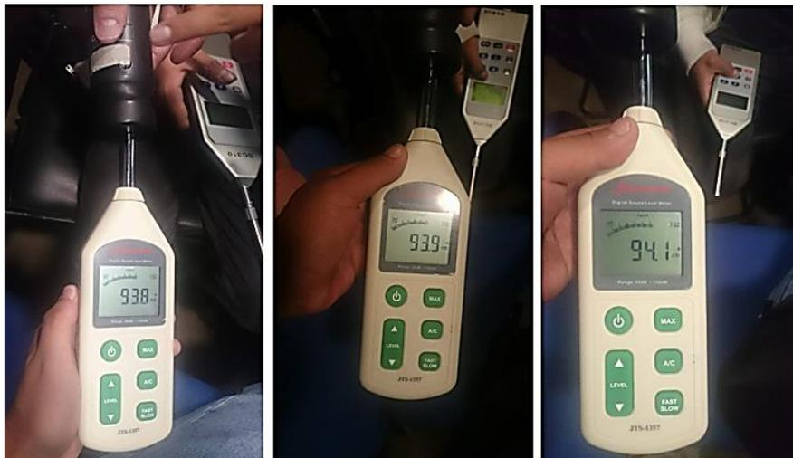
Figura 69. Calibración de los tres sonómetros JTS-1357
