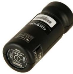
Figura 67. Calibrador acústico clase 1
