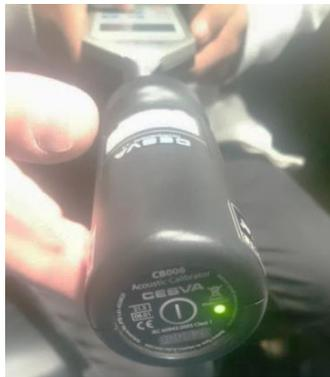
Figura 68. Calibración sonómetro CESVA
