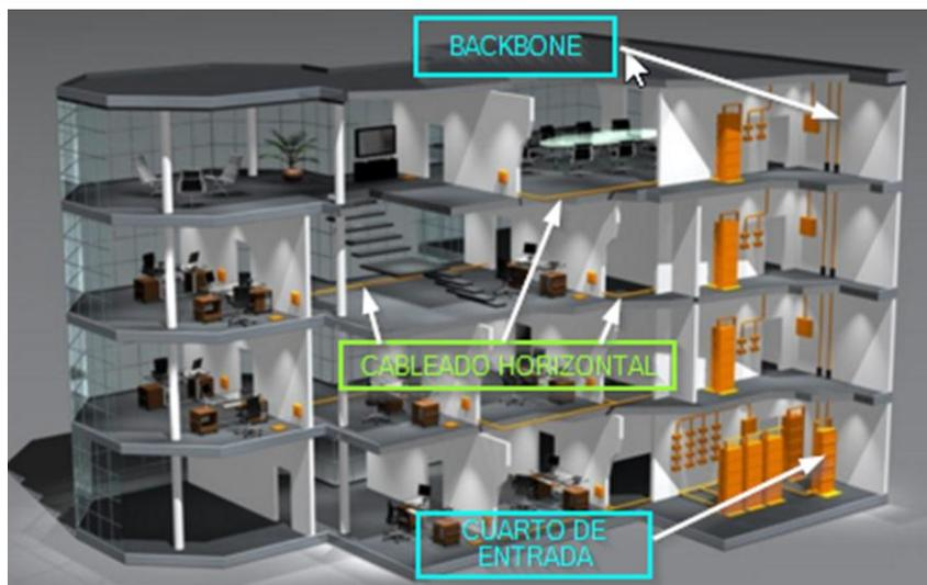
**Figura 2.** Cuarto de Entrada de un *Data Center*
