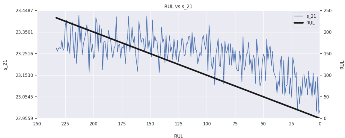
Ilustración 28: RUL vs medida del sensor 21
