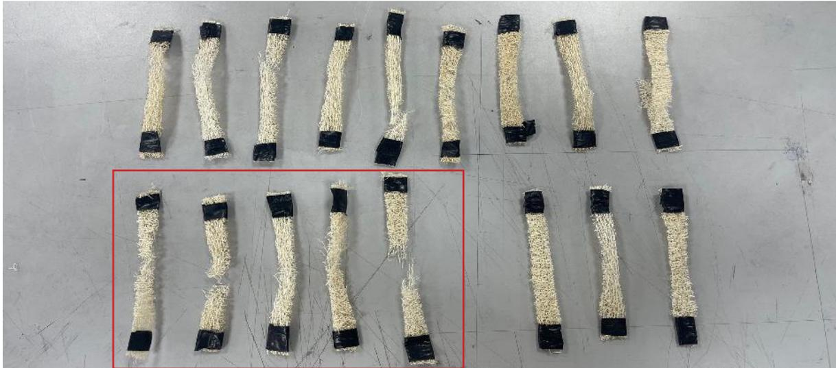
Figura 10. Probetas de luffa que experimentaron la tensión
