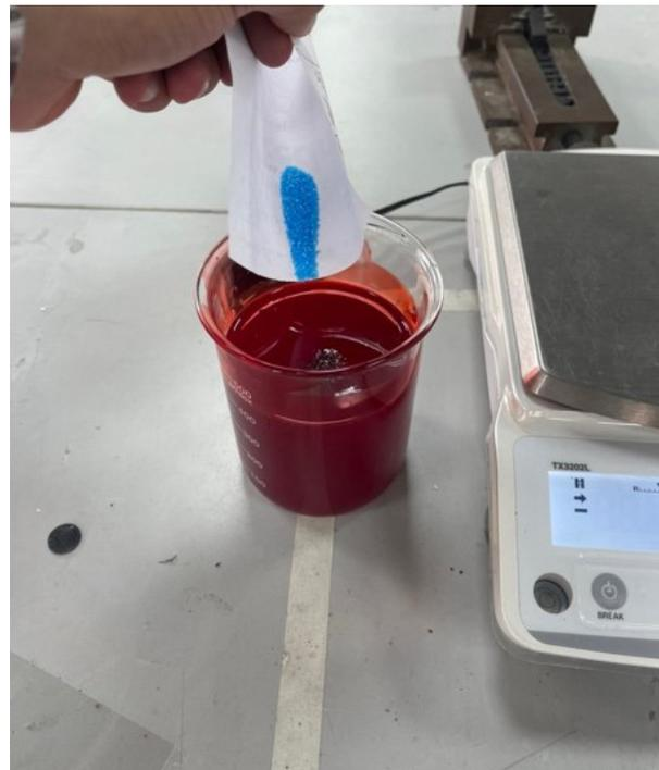
Figura 38. Agregado de sulfato de cobre
