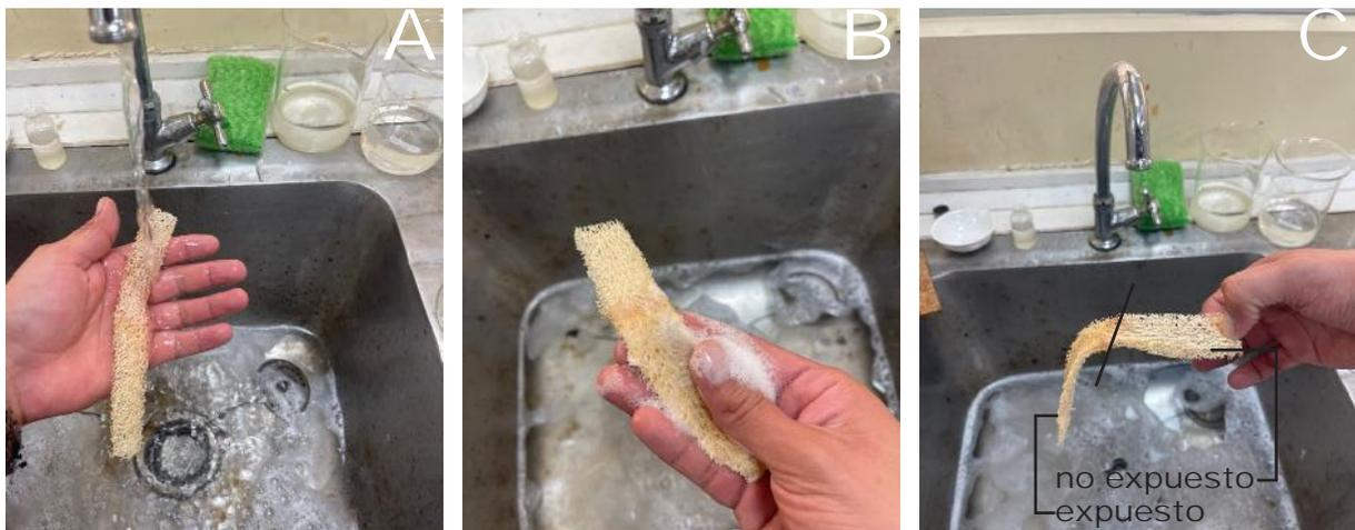
Figura 29. Proceso de lavado de probeta de luffa
