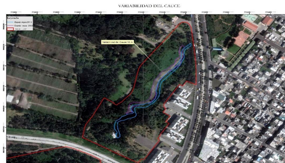
Figura 20. Variabilidad del Cauce en el Tramo Norte del PIT PZ27 (12 m de diferencia en 10 años)
